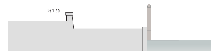
Højvandsikring langs Havnepromenaden - eksisterende forhold 1:100
